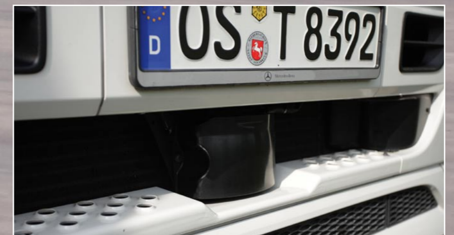
Praxistest: Drei der neuen Fahrzeuge sind mit einem Abstandswarngerät (unterhalb des Nummernschilds) ausgestattet. Es stoppt den Lkw, wenn eine Kollision mit einem vorausfahrenden Fahrzeug droht und der Fahrer nicht reagiert.
